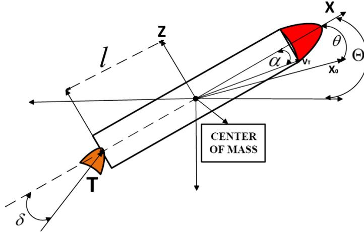
FIGURE 4. The missile parameters
